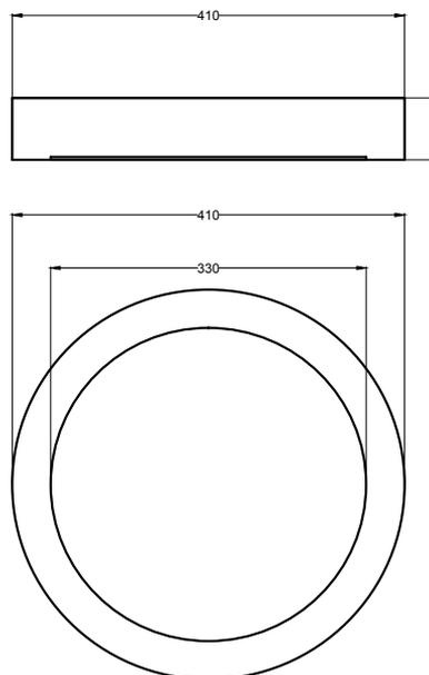
Wand- oder Deckenleuchte aus Stahlblech weiß Matt, indirekte Abstrahlung. Eignet sich hervorragend für die Raumbeleuchtung.
